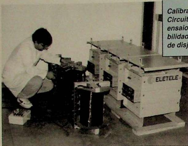
Calibração do Circuito de ensaio de durabilidade elétrica de disjuntores
