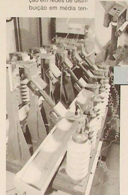
Montagem dos Corpos de prova para o ensaio de trilhamento
